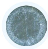
Cette résistance à la corrosion fait de Magnelis® le revêtement parfait pour les ventilateurs SISTEVEN. Après 1440 heures d'essais au brouillard salin sur une couche de revêtement Magnelis®, aucun oxyde rouge n'apparaît tandis que la couche de revêtement galvanisée est entièrement rouillée.
